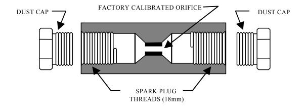
FIGURE 3 MASTER ORIFICE P/N 646953
