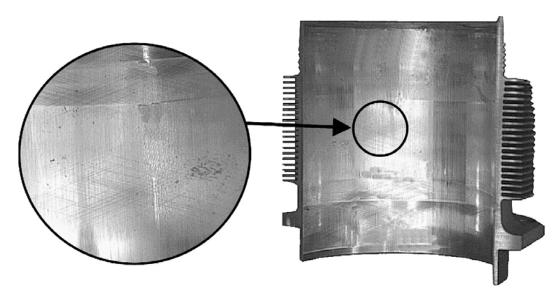
FIGURE 12 TYPICAL IN SERVICE CYLINDER BARREL
